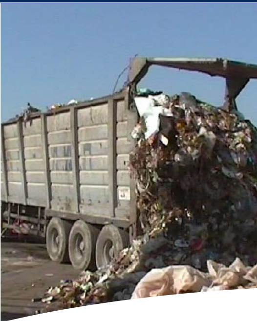
Heavy impact floor to transport and offload municipal waste Schwerlastboden für Transport und Entladung von Siedlungsabfällen
